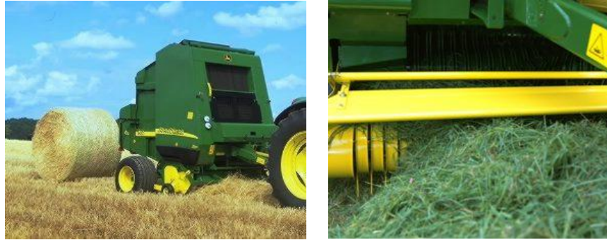
6 pav. Šiaudų presas (kairėje) ir šiaudų surinktuvas su integruotu smulkintuvu
