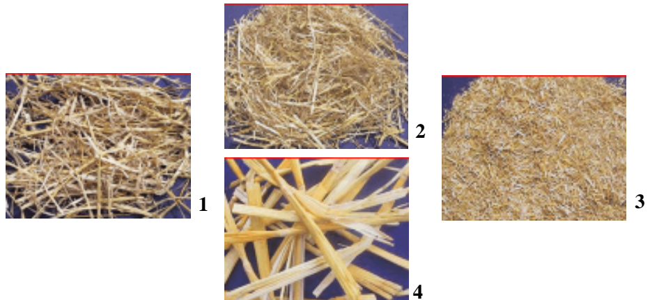
9 pav. Šiaudų smulkinimas: 1– palaidi sveiki šiaudai; 2 – sukapti šiaudai; 3 – galutinai susmulkinti šiaudai; 4 – susmulkintas šiaudas iš arti
