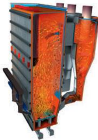
16 pav. Cirkuliuojančio verdančio sluoksnio sistema (CFB)
